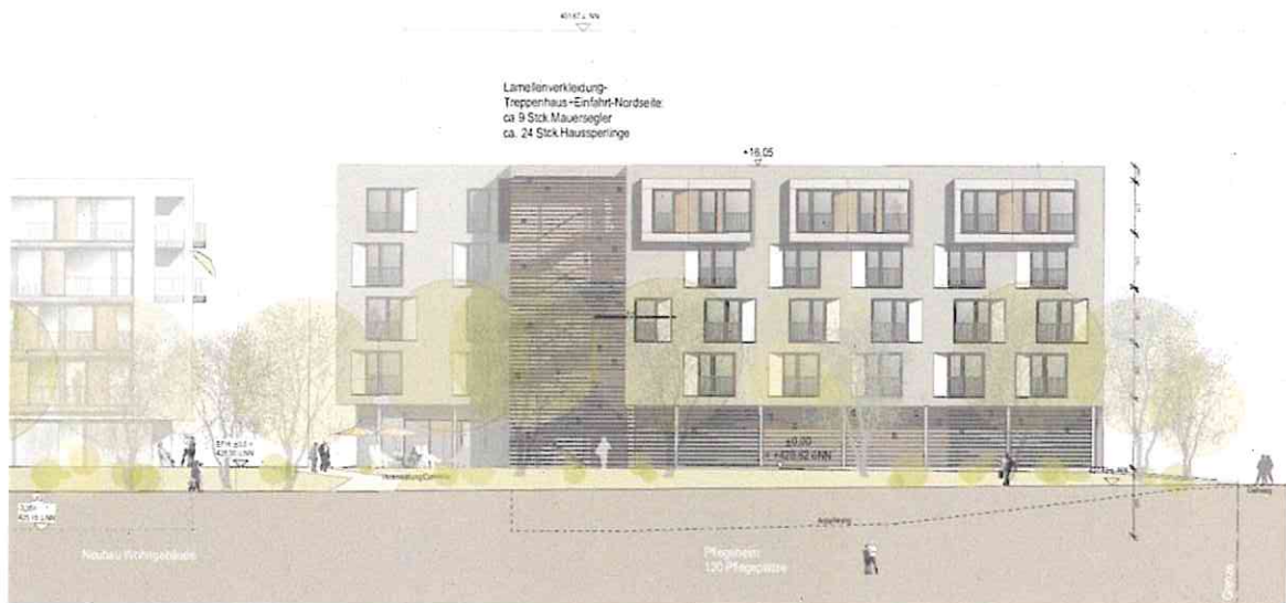
Abb. 4: Nordseite des Neubaus Pflegeheim mit ca. 9 Mauersegler- und 24 Haussperlingskästen in den Fugen der Lamellenverkleidung des Treppenhauses
