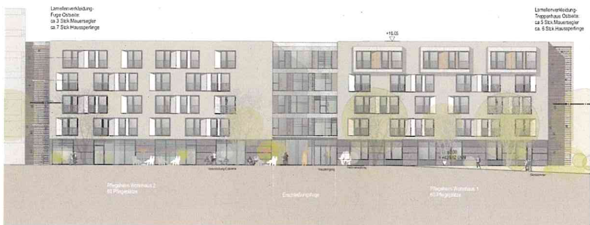
Abb. 5: Ostseite des Neubaus Pflegeheim mit ca. 8 Mauersegler- und 13 Haussperlingskästen in den Fugen der Lamellenverkleidung des Treppenhauses
