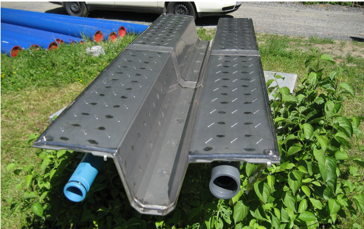
Abb. 3: Nachträglich einsetzbares Wärmetauschermodul
